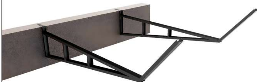
BANDEJA PRIMÁRIA FIXADA NA VIGA
